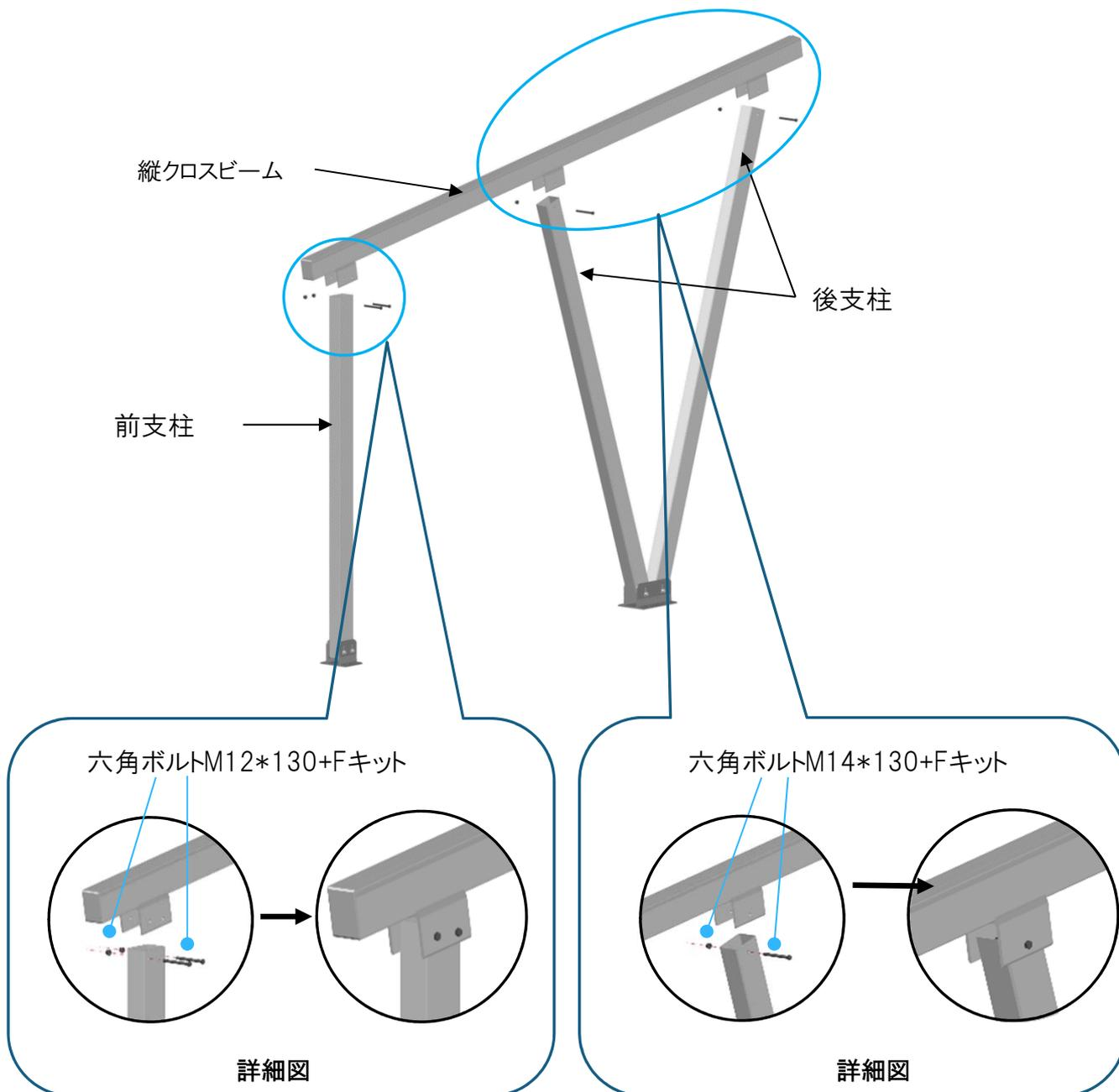
上図の通り、前支柱、後支柱、縦クロスビームを組み立てます。
