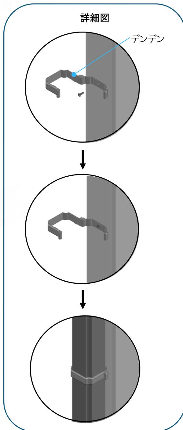
左前の支柱にデンデンをネジ止めし、堅樋を取り付けます。
