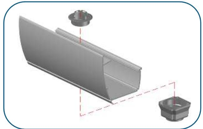
2. 化粧カバーを左右均等になるような位置に調整し、ベースレールへ掛けるように設置します。
