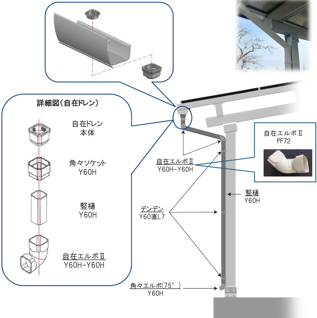
※1: 縦樋は現地にて計測の上、必要な寸法に切断してご使用ください。
