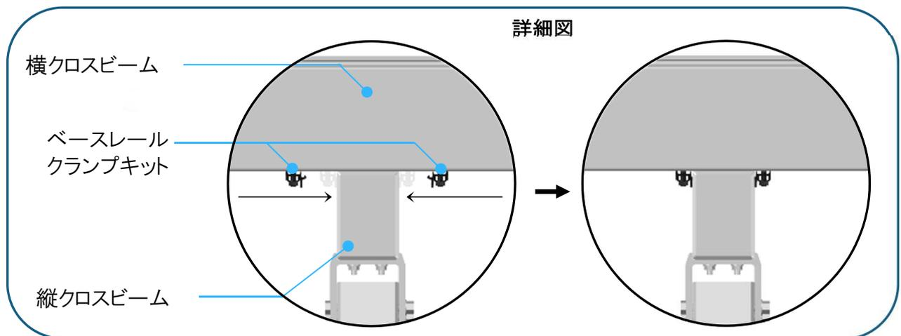
1. 横クロスビームの下側に固定クランプ(ベースレールクランプキット)があります。そのクランプを移動し、縦クロスビームを挟むように隙間を開けます。
